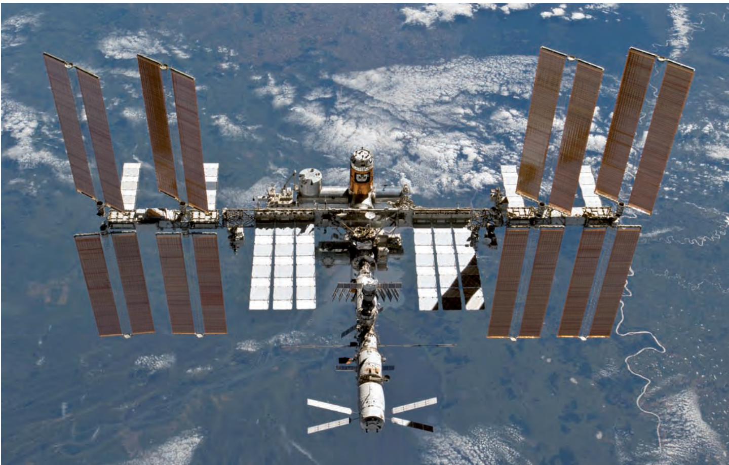
Die internationale Raumstation ISS – noch ohne Spiegel, aber mit Sonnenkollektoren für eine autarke Energieversorgung im All
